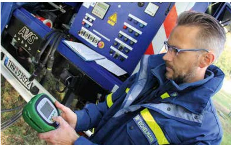
Spannungsgeladene Kopfarbeit: Bei Übungen zur Elektroversorgung wie im sachsen-anhaltischen Havelberg mussten THW-Kräfte akribisch messen und rechnen, um beispielsweise den richtigen Widerstand für Erdungen zu bestimmen. | High-potential brainwork: In power supply exercises, such as this one in Saxony-Anhalt Havelberg, THW volunteers had to precisely measure the electrical parameters and calculate, for example, the right resistance for earthing.
