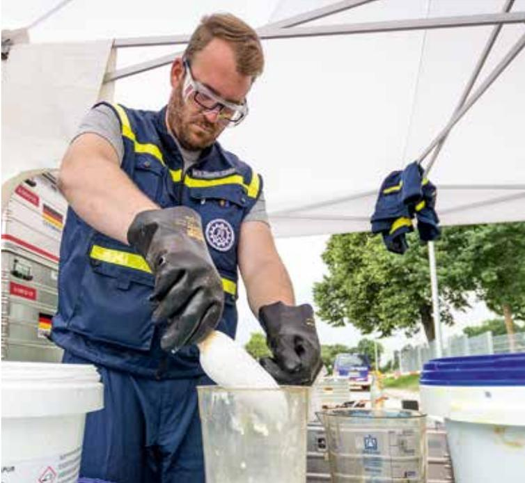
Bevor THW-Kräfte das Wasser durch Keramikmembranen filtern, setzen sie Chemikalien ein, um das Trinkwasser zu reinigen. | Before THW experts filter the water through ceramic membranes, they purify the drinking water using chemicals.
