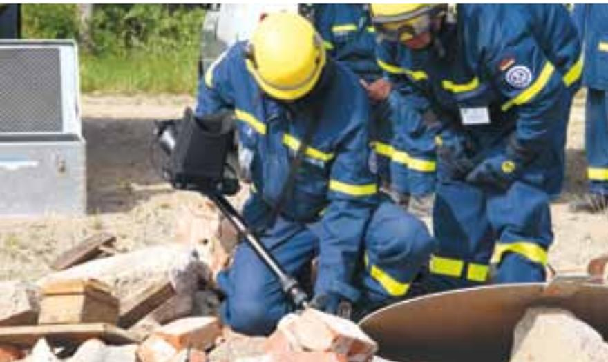
**THW-Kräfte orten mit einer Endoskop-Kamera Verschüttete in den Trümmerhaufen.**
